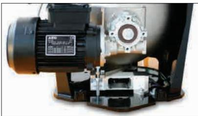
GRADO-ADROIT impiega una camera di miscelazione a perdita di peso, a fondo semisferico, installata su una cella di carico che pesa, in continuo, i materiali utilizzati. Il sistema può misurare e controllare la portata di estrusione oppure la velocità della linea o, in alternativa, eseguire le due funzioni simultaneamente. Con linee multi-strato la portata di ogni estrusore viene misurata e controllata, per mantenere costante il rapporto percentuale fra i vari strati.
