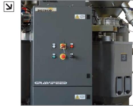
Dosatore gravimetrico continuo, progettato per il dosaggio di materiali in granuli, macinati e in scaglia nei processi di estrusione in cui la precisione di dosaggio e la capacità di adeguarsi e di compensare le variazioni di processi instabili sono requisiti imprescindibili.
