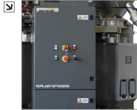
Dosador gravimétrico contínuo projetado para a dosagem de materiais em grânulos, moídos e em lasca nos processos de extrusão nos quais é imprescindível a precisão de dosagem e a capacidade de se adequar e de compensar as variações de processos instáveis.
